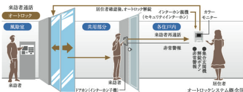
セキュリティシステム概念図※敷地内に設置された防犯カメラの画像は管理員室にて録画(一定期間)される仕組みになっています。
